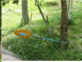
チルホールと滑車を使って倒す方向を見極めて除伐
